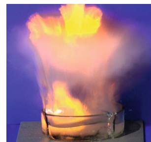
Feu alcalin avec du sodium
